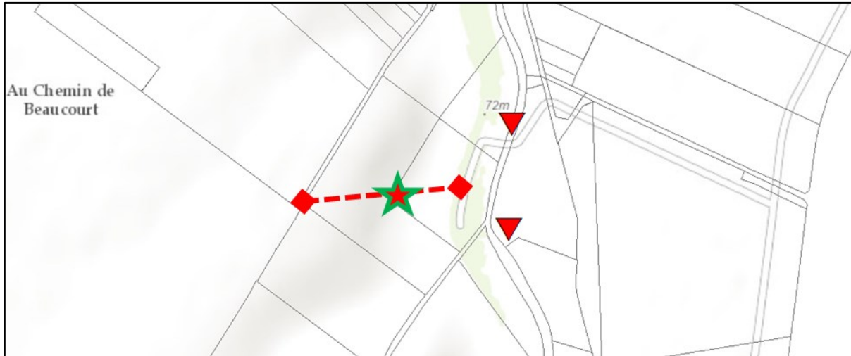
(localisation sur fond IGN de la coupe et des 2 forages AEP de Caix 3) Figure 48 : Représentation conceptuelle du modèle 2D de Caix sous MARTHE-MONICA
